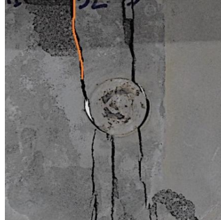
Gambar 6. Pola Retak pada Benda Uji Mortar-Inklusi
