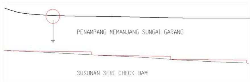
Gambar 1. Penampang memanjang Sungai Garang dan Susunan Seri Check Dam
