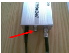
Gambar 3. Pemasangan Catu Daya pada DVB Card.
