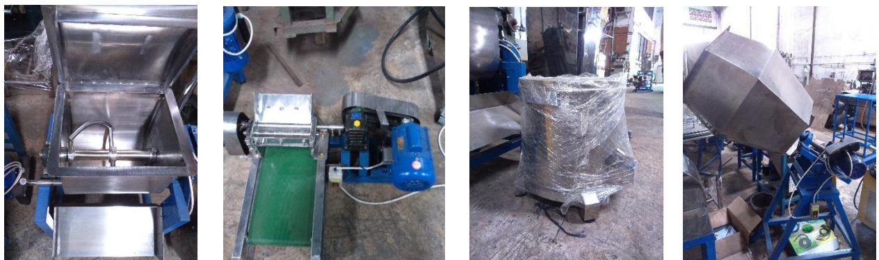
Gambar 1. Kiri ke Kanan: 1) mesin pengaduk, 2) mesin pemotong lembaran tortila, 3) spinner, dan 5) mesin pencampur bumbu kering
