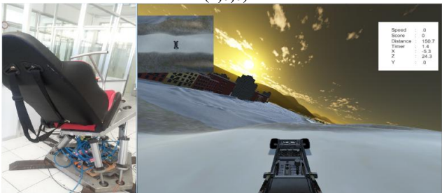
Gambar 10. Gerakkan Diskrit Hexapod dengan dengan input (0,1,0)
