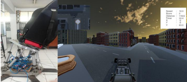
Gambar 8. Gerakkan Diskrit Hexapod dengan dengan input (0,0,1)
