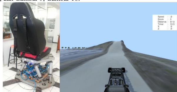
Gambar 6. Gerakan Diskrit Hexapod dengan dengan input (0,0,0)
