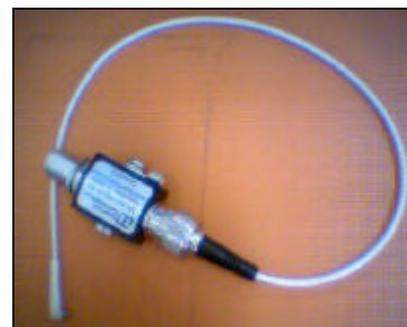
**Gambar 15. Konverter Coaxial ke Konektor Antena Device Orinoco**
