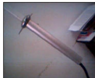
**Gambar 14. Antena Omni, Kabel dan Pipa Penyangga**
