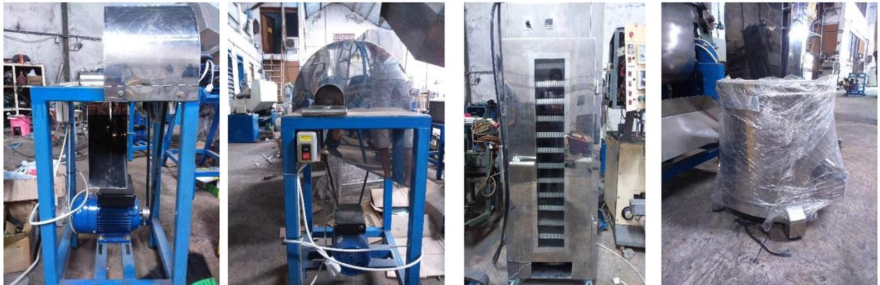
Gambar 1. Kiri ke Kanan: 1) mesin pemotong singkong, 2) mesin pemotong kerupuk beras lontongan, 3) pengering kabinet, dan 4) spinner
