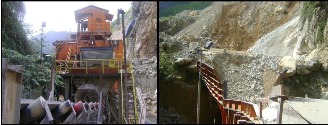
Gambar 1. Mobile crusher dan Hopper
