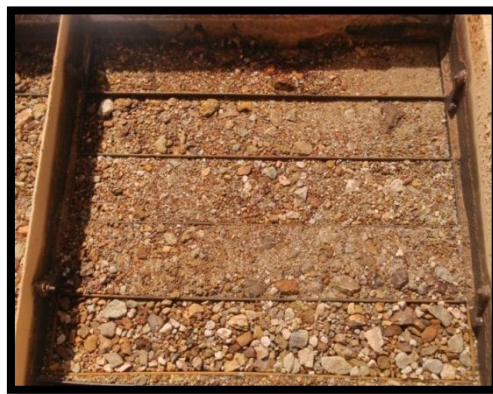
Gambar 2. Jig Bed di Instalasi Pencucian Bijih Timah TB 1.42 Pemali
